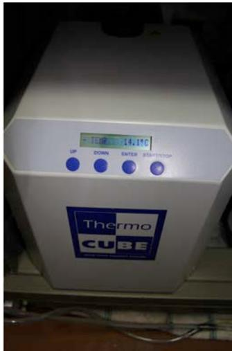
Figure 11: Le Thermo-cube se trouve dans le local électronique de Sophie. Il permet de réguler la température de l'air autour du spectrographe. Le thermo-cube fonctionne avec un circuit d'eau refroidi à 14°C (voir affichage du boîtier dans la salle électronique sur cette photo)
