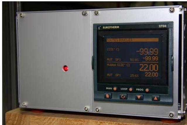
Figure 12: Boîtier de control de la régulation de la température du CCD. En haut s'affiche la température du CCD et la consigne nominale pour la régulation (-99.99). En bas, on voit la température du hublot (régulé par de petites résistances) devant le CCD et la consigne (22 °C). Si ces chiffres changent, c'est qu'il y a un problème thermique (ex: plus d'azote, vide du cryostat défectueux, etc.)
