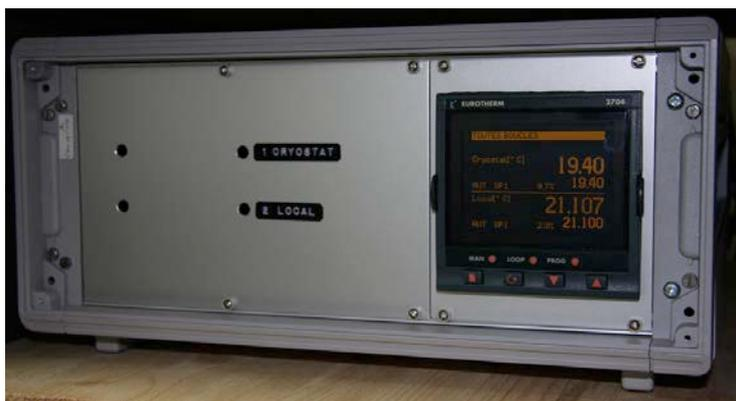
Figure 13: Température et consigne de régulation de la partie extérieur du cryostat (en haut) et du local Sophie (en bas). Si la température du local devient différente de la consigne, vérifier la température de l'eau du thermo-cube (Figure 11). On refroidit de l'eau à 14°C et des résistances régulent le thermo-cube (donc l'air de la salle Sophie) à 21.1 °C (permet d'avoir une régulation rapide et plus précise).
