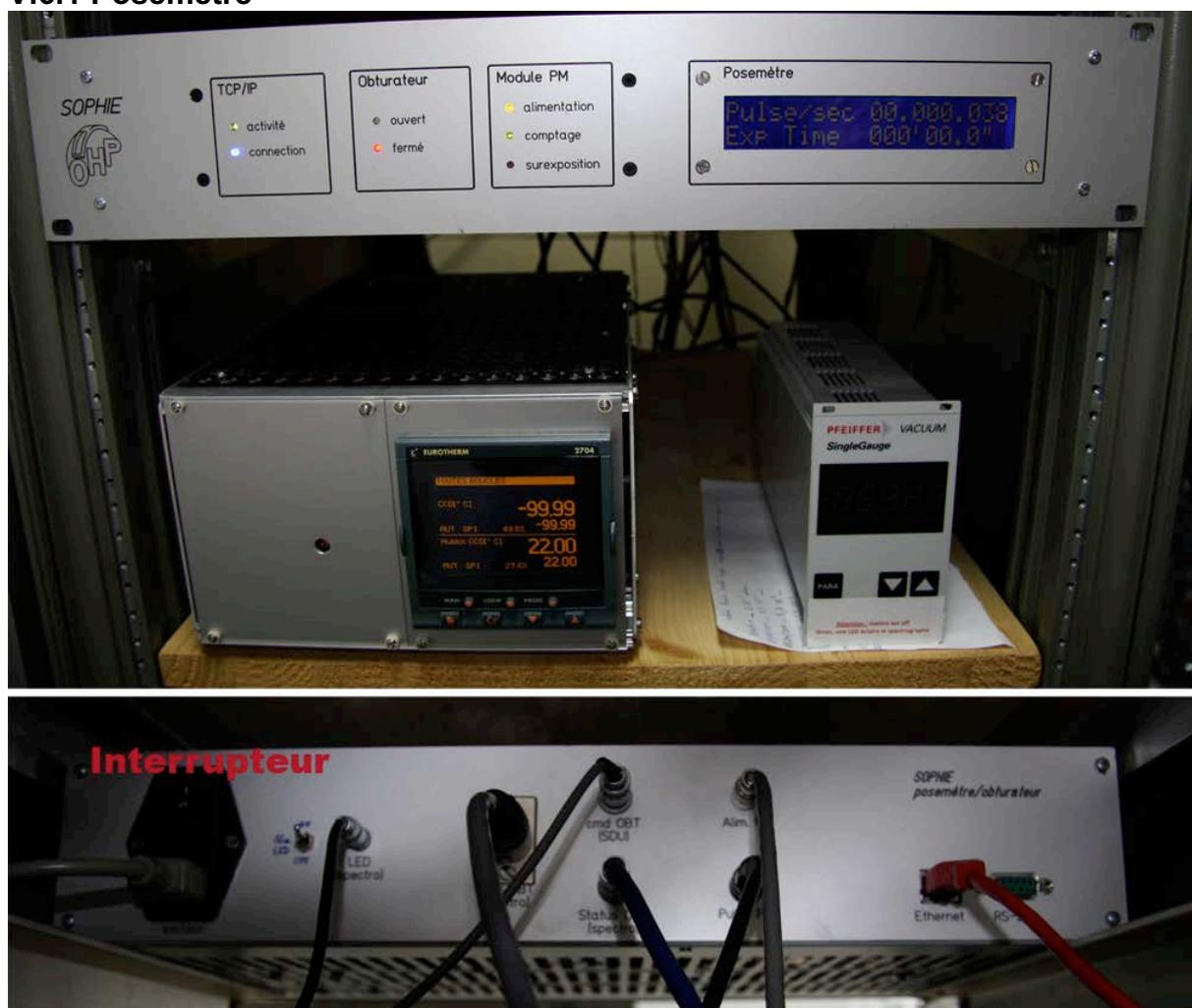
Figure 10: Photo du boîtier du posemètre (salle électronique Sophie). N'éteindre l'interrupteur qu'après avoir tout essayé (redémarrage du PC Sophie et réinitialisation soft).
