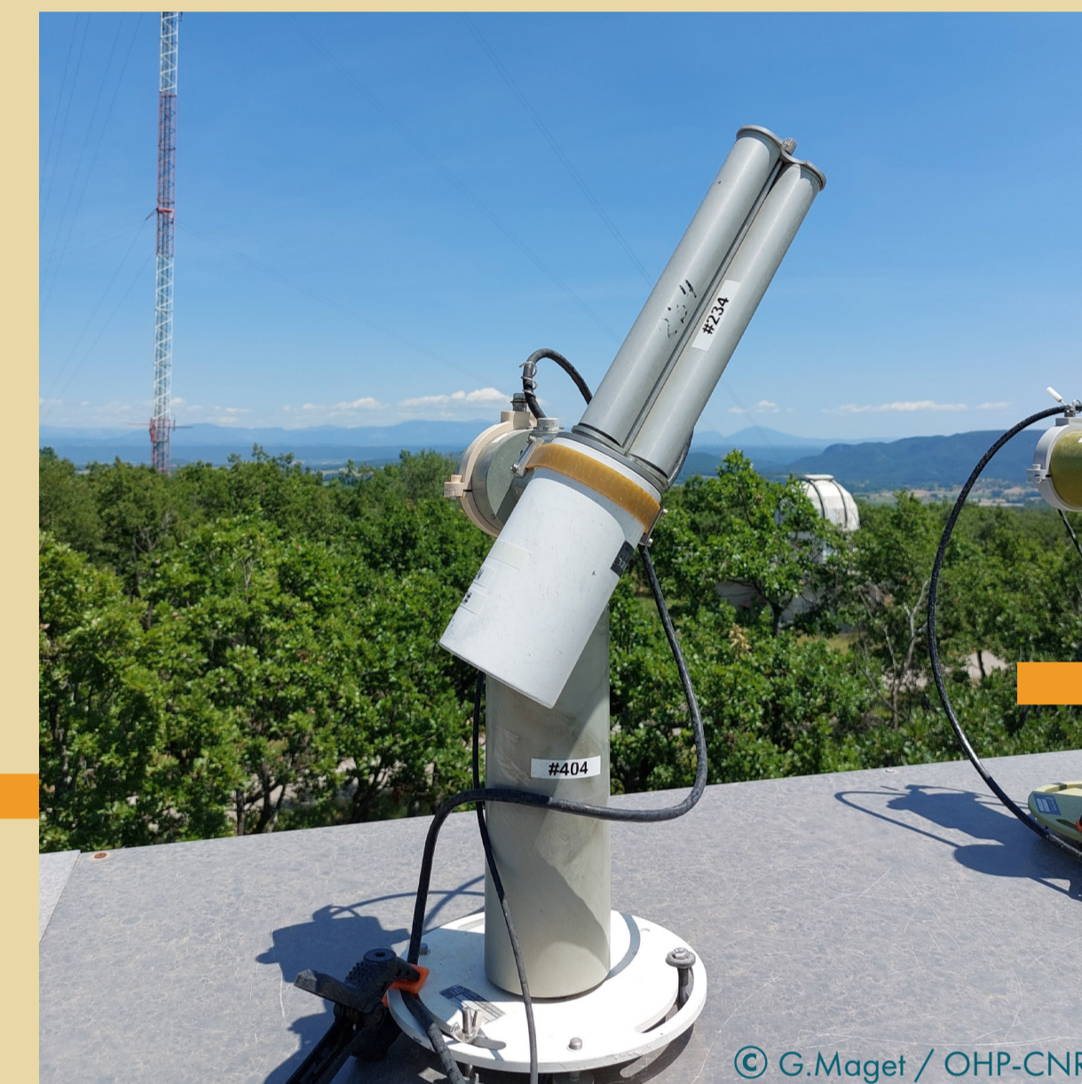
Photomètres du réseau PHOTON à l'OHP PHOTON network Photometers at the OHP
